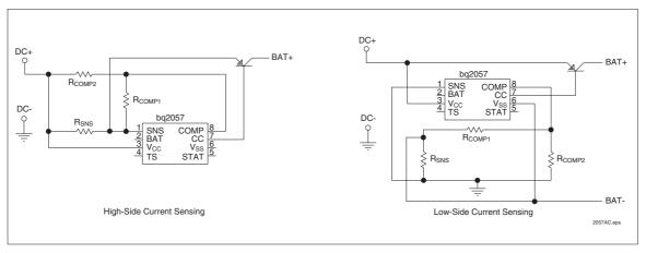
Figure 12. AutoComp Circuits
