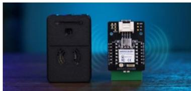
XIAO 60 GHz 毫米波人体跌倒检测传感器
